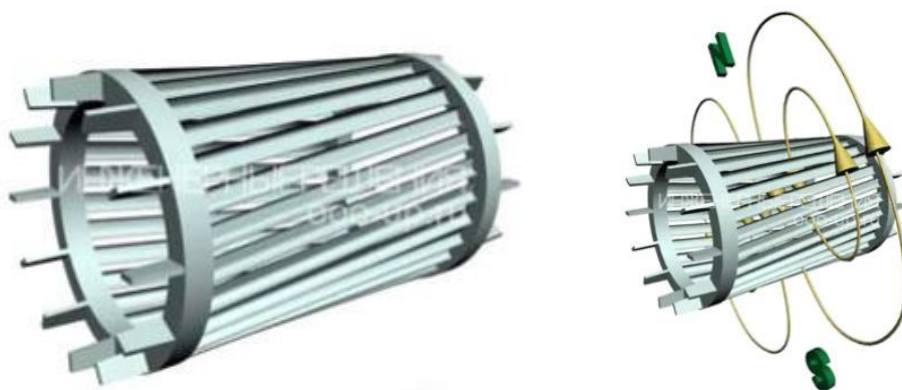
Рисунок 6 -Короткозамкнутый ротор "беличья клетка" наиболее широко используемый в асинхронных электродвигателях (показан без вала и сердечника)
