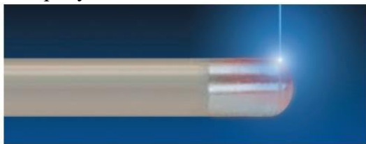
Рисунок 1а-Лазерная сварка оболочки первичного преобразователя
